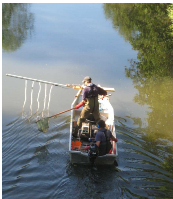
Abb. 3: Bootbefischung mit Elektrofischereigerät FEG 11000 und Anodenrechen
